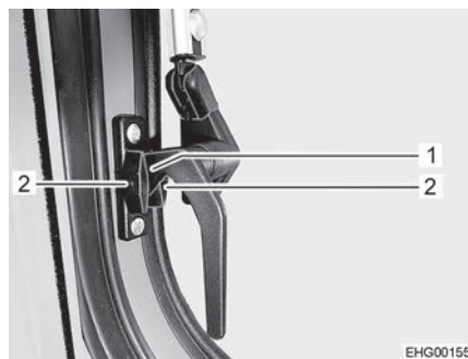
Bild 42 Låsarm, i sidan (i läget "kontinuerlig vädring")
