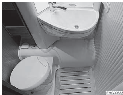
Bild 152 Toalettstol, vriden mot väggen
