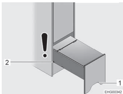
Bild 82 Klättringshjälp (helt utdragen)
