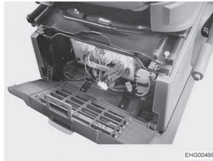
Afb. 97 Inbouwplaats elektroblok (Stellantis)
