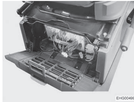
Afb. 76 Inbouwplaats elektroblok (Stellantis)
