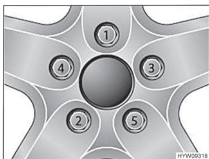
Afb. 130 Wielmoeren of wielschroeven kruisgewijs vastdraaien
