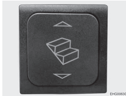
Fig. 4 Interruttore di comando scalino di ingresso
