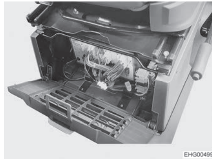
Fig. 97 Ubicazione centralina elettrica (Stellantis)
