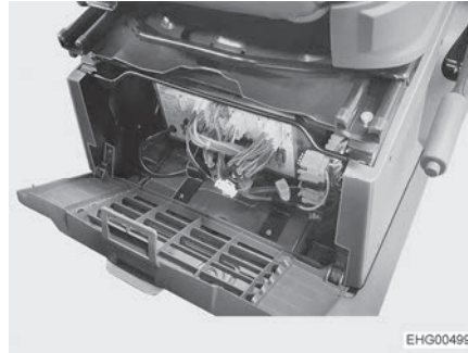
Fig. 76 Ubicazione centralina elettrica (Stellantis)
