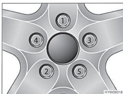
Fig. 130 Serraggio a croce di dadi delle ruote e bulloni delle ruote
