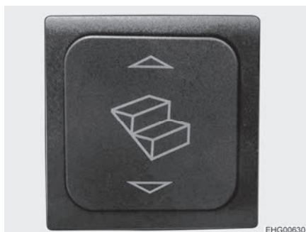
Fig. 3 Interruttore a bilico scalino di ingresso
