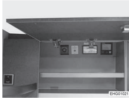
Fig. 118 Porte-fusibles sur les véhicules avec conduite à droite (Ford)
