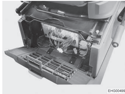
Fig. 97 Emplacement bloc électrique (Stellantis)
