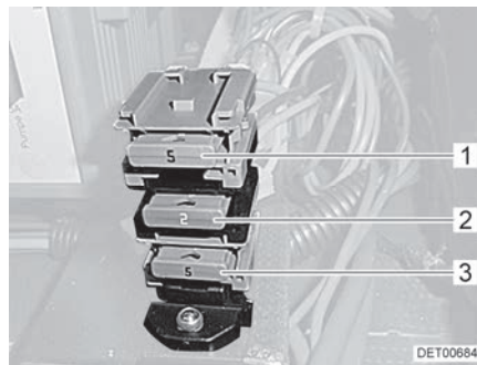
Fig. 110 Fusibles à côté du bloc électrique (Stellantis)
