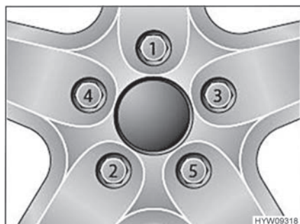
Fig. 130 Serrer en croix les écrous ou les boulons de roue
