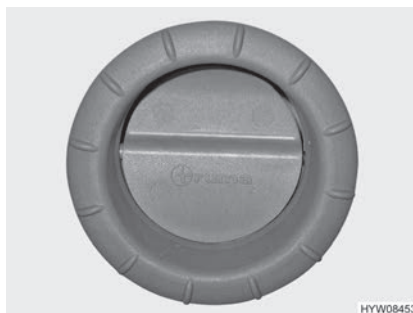
Fig. 94 Buse de sortie d'air (chauffage à air chaud)
