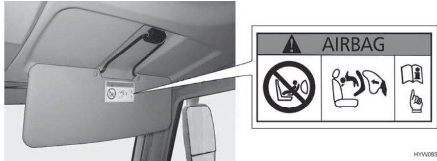
Fig. 11 Indication de sécurité du système de retenue pour enfants (pare-soleil du passager)
