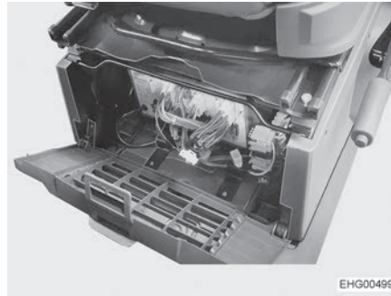
Kuva 97 Sähkö- ja elektroniikkayksikön asennuspaikka (Stellantis)
