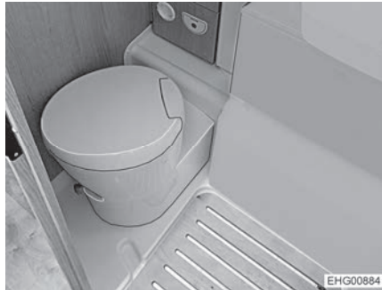
Kuva 156 WC-istuin, käännetty seinää päin
