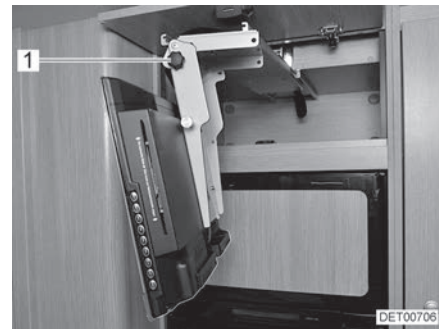
Kuva 66 Litteä kuvaruutu katseluasennossa
