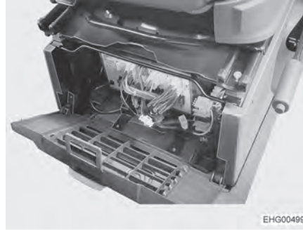
Kuva 74 Sähkö- ja elektroniikkayksikön asennuspaikka (Fiat/Citroën)
