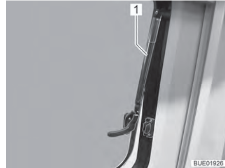
Kuva 19 Avattavat ikkunat, joissa on automaattipidikkeet, avattu
