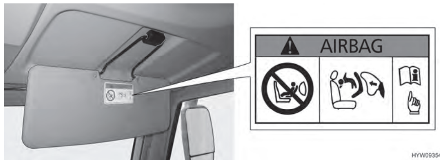
Kuva 11 Lasten turvalaitteisiin liittyvä varoitus (apuohjaajan häikäisy suoja)
