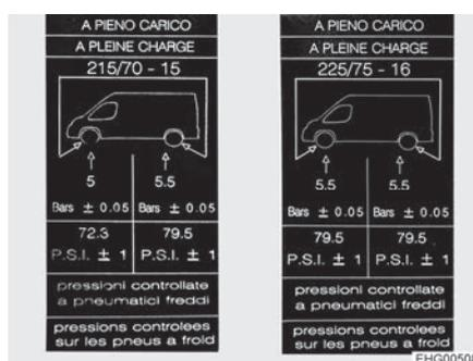
Fig. 178 Etiqueta adhesiva de información acerca de la presión de los neumáticos en la columna B (ejemplo)
