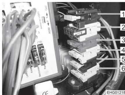
Fig. 111 Fusibles junto al bloque eléctrico (Ford)
