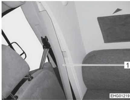
Fig. 116 Revestimiento de la columna B (Ford)
