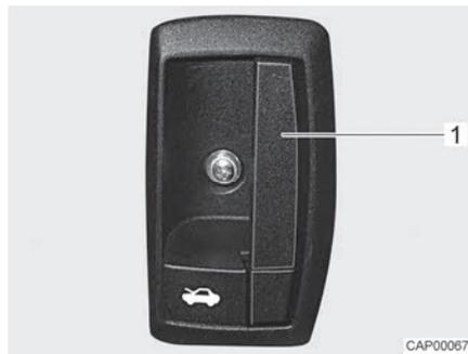
Fig. 9 Palanca de desbloqueo (capó del motor)
