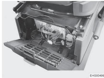
Fig. 97 Lugar de instalación del bloque eléctrico (Stellantis)
