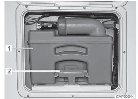
Fig. 162 Depósito de aguas fecales
