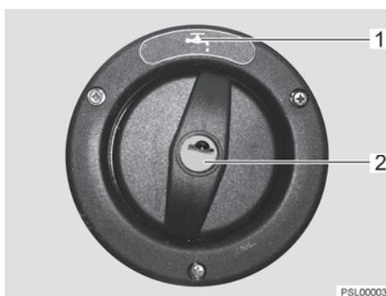
Fig. 140 Tapa de cierre para el tubo de llenado de agua potable
