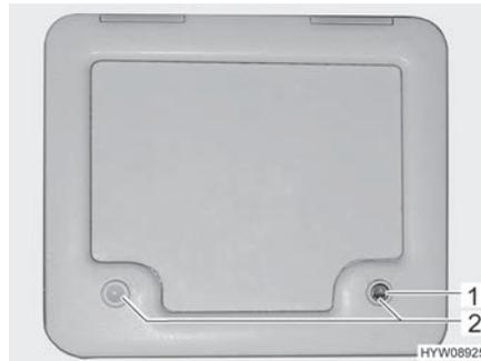
Fig. 161 Trampilla para el depósito de aguas fecales
