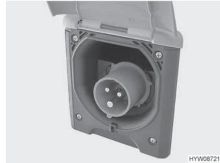
Fig. 102 Conexión de 230 V en el vehículo (caja de enchufe CEE)
