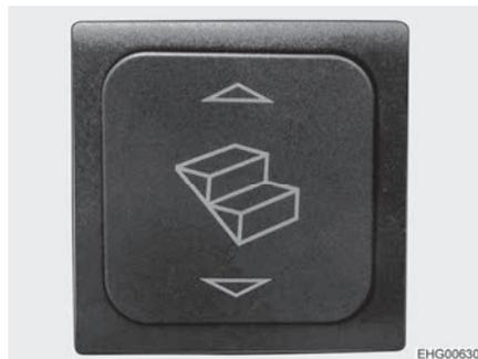
Fig. 4 Conmutador de mando del escalón de entrada
