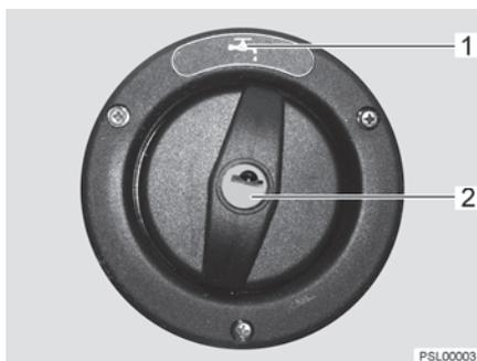
Fig. 106 Tapa de cierre para el tubo de llenado de agua potable
