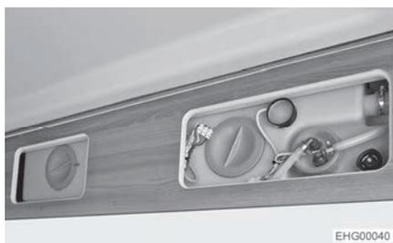
Fig. 105 Depósito de agua
