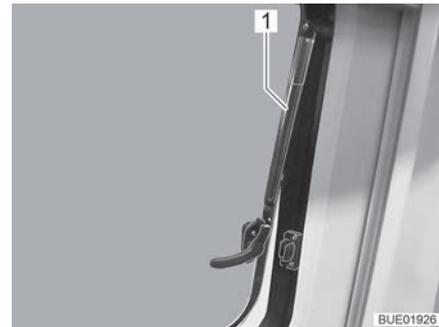
Fig. 20 Ventana abatible con soportes automáticos, abierta
