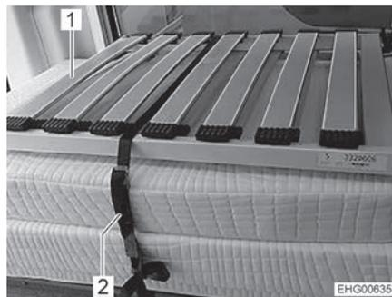
Fig. 40 Cama trasera (posición de transporte)
