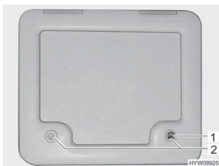
Fig. 119 Trampilla para el depósito de aguas fecales
