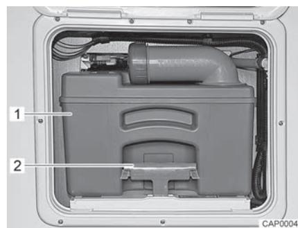
Fig. 120 Depósito de aguas fecales
