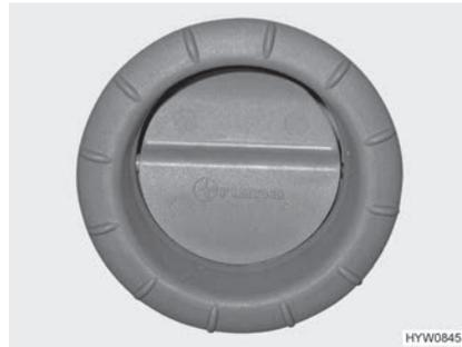
Fig. 94 Boquilla de salida de aire (calefacción de aire caliente)
