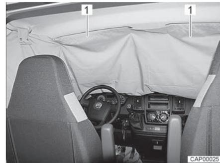
Fig. 25 Oscurecedor de la cabina del conductor en la luna delantera
