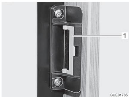
Fig. 103 Dispositivo de cierre en posición normal
