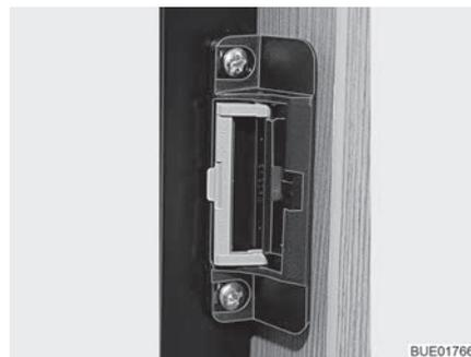
Fig. 104 Dispositivo de cierre en posición de ventilación
