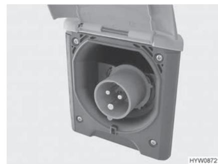
Fig. 81 Conexión de 230 V en el vehículo (caja de enchufe CEE)
