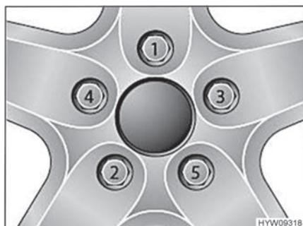
Fig. 130 Apretar las tuercas o los tornillos de las ruedas en forma de cruz
