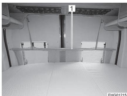
Fig. 50 Protección contra caídas (cama trasera longitudinal)
