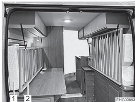
Fig. 47 Colchones y somieres en posición de transporte
