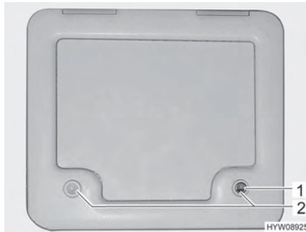
Bild 161 Klappe für den Fäkalientank
