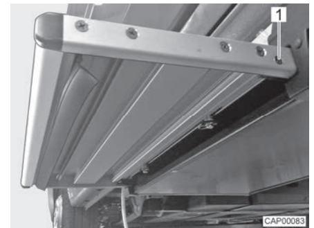
Fig. 122 End stop (entrance step)
