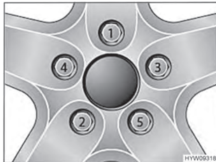
Bild 130 Radmuttern oder Radschrauben über Kreuz festziehen
