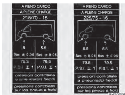
Bild 132 Hinweisaufkleber zum Reifendruck an B-Säule (Beispiel)
