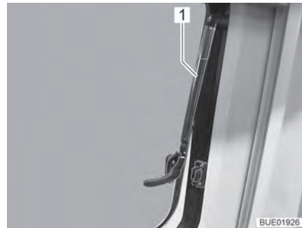
Bild 20 Ausstellfenster mit Automatik-Ausstellern, geöffnet
