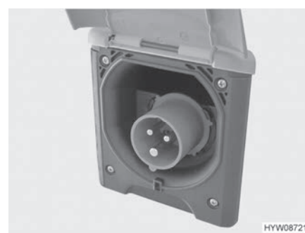
Bild 81 230 V-anslutning på fordonet (CEE-uttag)
