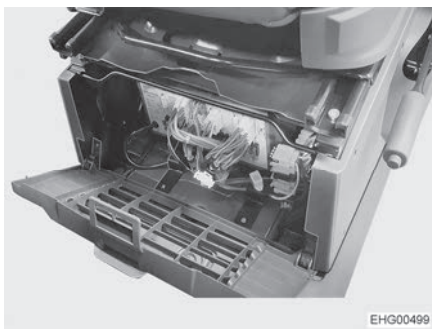
Bild 76 Monteringsställe el-block (Stellantis)
