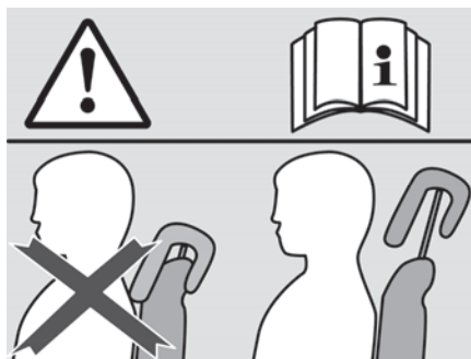
Bild 16 Korrekt inställning av nackstöden
