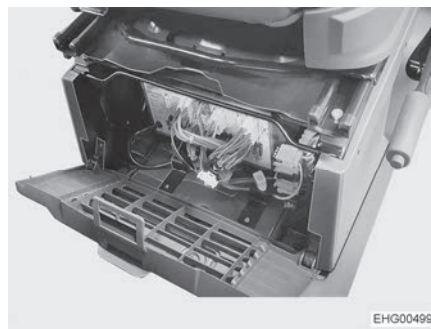
Bilde 97 Monteringssted for strømsentralen (Stellantis)
