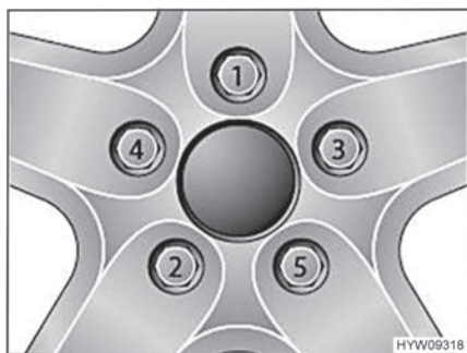
Bilde 130 Trekk til hjulmutrene eller hjulskruene over krysset
