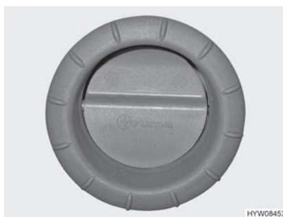
Bilde 94 Luftdyse (varmlufts-varmeanlegget)
