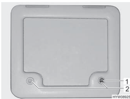
Bilde 119 Klaff for kloakktanken
